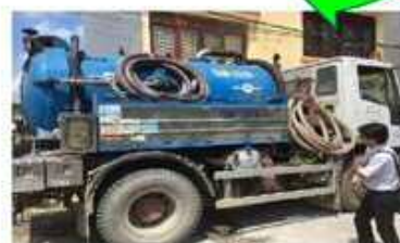
バキュームカー 腐敗槽（セプティックタンク）に堆積した汚泥を引き抜いている。
